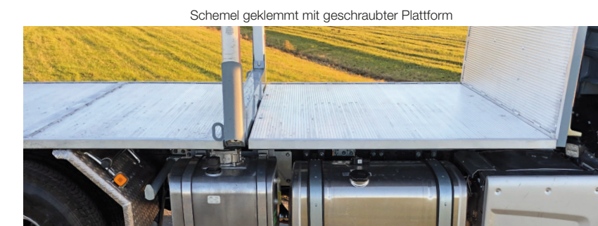
Schemel geklemmt mit geschraubter Plattform
